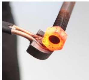
Lösen festsitzender Muttern/Bolzen
